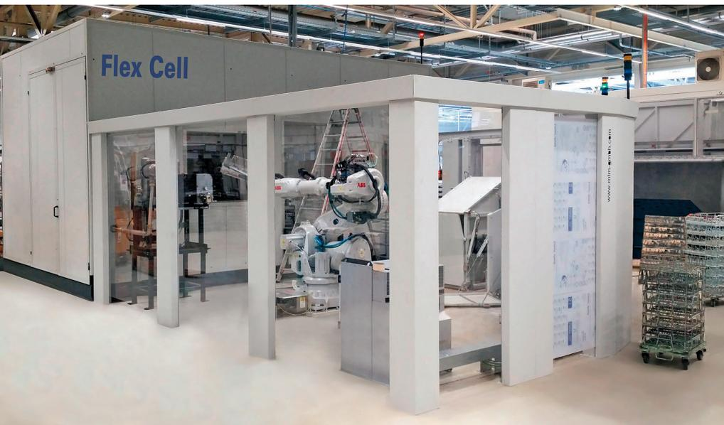
1 Die FlexCell-Anlage ist ausgelegt für Reinigungsprozesse wie Flutinjektionswaschen, Spritzwaschen, Tauchwaschen, Spritzspülen, HD-Entgratung und Trocknungsprozesse wie Vakuum- und Warmlufttrocknung © mtm
